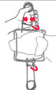
5. Comprima el segundo resorte y abra las mandíbulas de la trampa o sujete su pestillo de seguridad.
